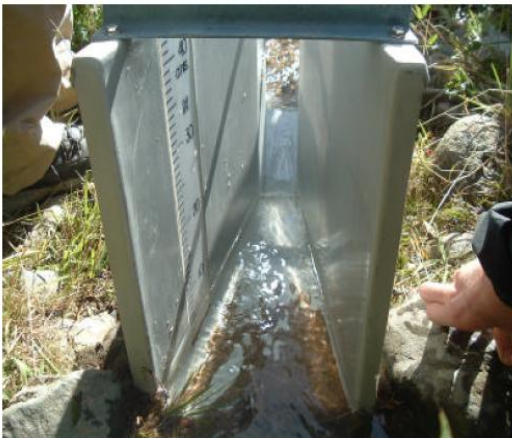
Fig. 2.35a. Vista general Canal Parshall, se aprecia la sección convergente de entrada, la sección de la garganta y la sección divergente.
