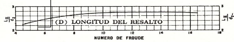
Figura 3.33. Características de los tanques amortiguadores para números de Froude mayores de 4.5 cuando las velocidades de llegada no exceden de 50 pies/seg.
