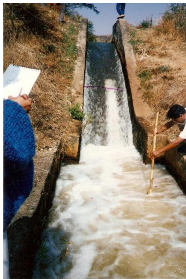
Figura 2.15. Ocurrencia de la profundidad crítica en caída inclinada
