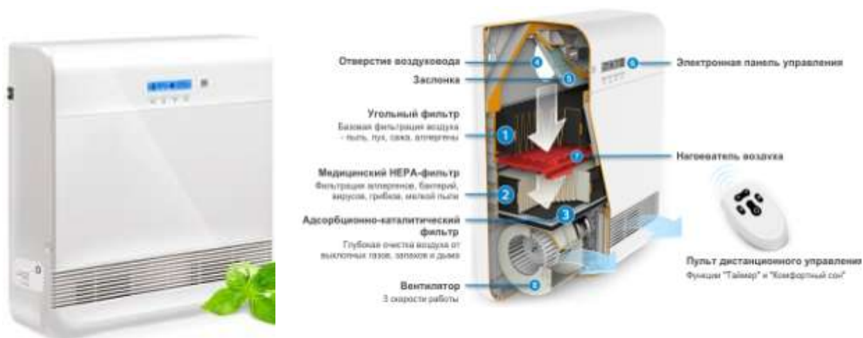
Рис. 3 – Внешний вид и внутреннее устройство бризера Тион O2
