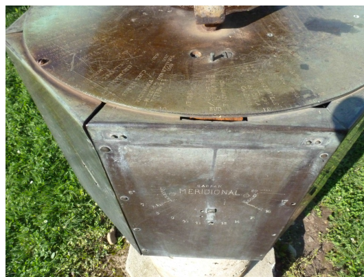
Figure 8 – Table d'orientation, cadrans verticaux et traces des fixations des cadrans basculants.
