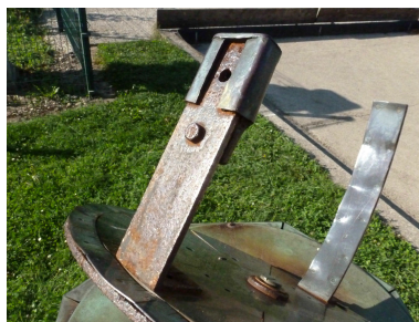
Figure 3 – Alidade avec porte-lentille et plaque de la courbe en huit.
