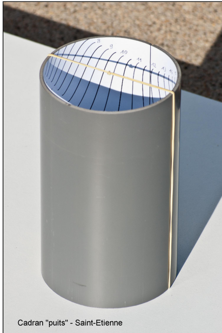
Figure 5 – Réalisation du cadran. Cette maquette pourrait, bien sûr, être améliorée. En particulier on pourrait découper, sur l'avant du cylindre, une fenêtre qui permettrait une lecture plus aisée des heures de printemps et d'été et qui modifierait l'allure de l'objet en le faisant évoquer une personne accueillante qui ouvre les bras. Il ne faut pas oublier de mentionner ici les très élégantes et diverses réalisations de ce cadran faites par N. Aebischer, spécialiste des «soleilheurs», cadrans solaires qui donnent l'heure légale. Elle utilise des cylindres transparents et divers gnomons. La visite de son site s'impose [10].
