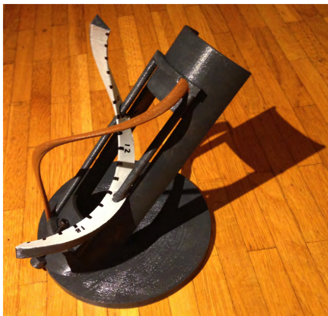
Figure 2 – Prototype de cadran à double hélice, avec réglage par translation du style. Il a été réalisé en ABS par impression 3D, puis peint. Le style est brun clair, monté sur un support avec deux barres coulissantes.
