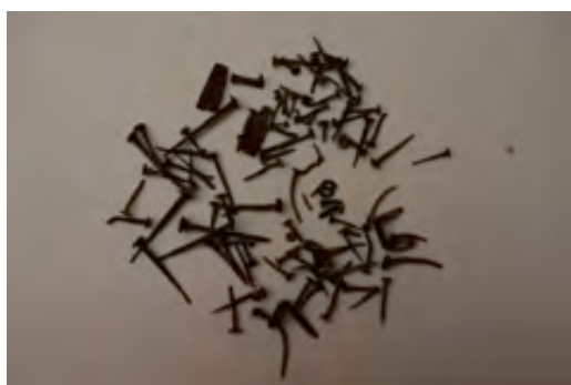
(a) Les anciens clous sont récupérés et réparés
