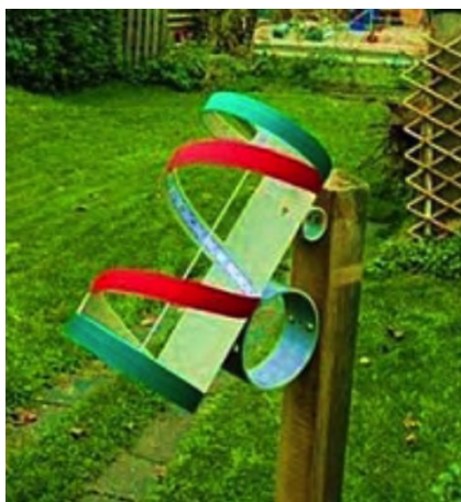
Figure 3 – On trouve la description d’un cadran à hélice circulaire dans un brevet de 1990 [1], ainsi que dans la publication néerlandaise Zonnewijzerkring [2], et une analyse détaillée d’un cadran hélicoïde dans Cadran Info n° 12 [3] qui fonctionne sans style, la lecture se faisant à la jonction ombre-lumière de la surface en hélice.
