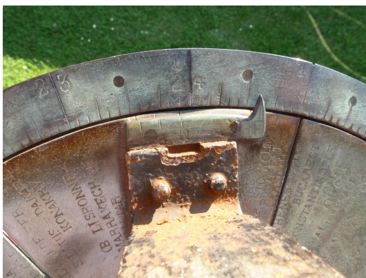
Figure 7 – Graduations sur la couronne des heures, inscriptions sur le disque des villes et index de lecture.
