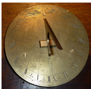
(a) Cadran solaire horizontal signé Gourdin à Paris (vers 1780). Tracé pour une latitude de 49^\circ
