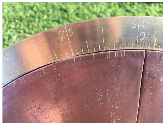
Figure 10 – Nouvelle couronne de lecture gravée manuellement.
