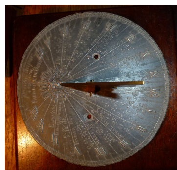
(c) Cadran solaire horizontal « fabrique de Paris ». Probablement fin XVIII e siècle. Indication de l'équation du temps. Alliage plomb étain ?
