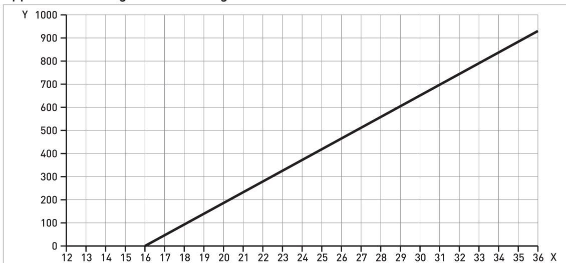
Figure 2-2: Tension minimale d'alimentation pour une sortie de 21,5 mA aux bornes (homologation zones dangereuses (Ex d / XP/NI))
