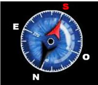
**Hinweis:** Für eine hohe Genauigkeit des Kompasses, achten Sie bei der Ablesung darauf, dass Sie sich nicht in der Nähe von großen Metallobjekten oder Elektrokabeln befinden. Führen Sie außerdem die Ablesung mehrfach durch.
