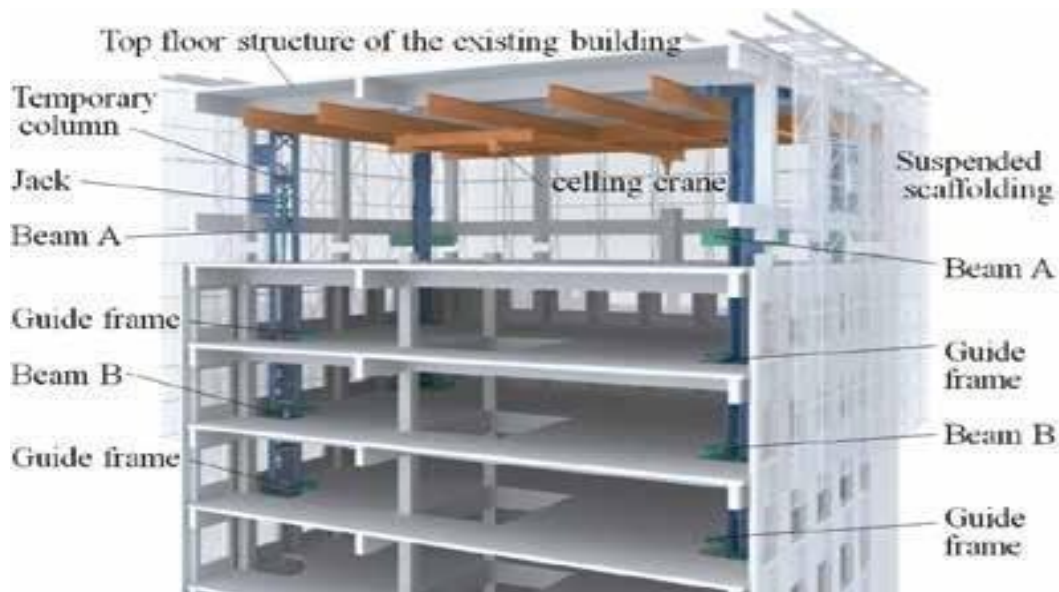
Εικόνα 2. Σύστημα TECOREP (Πηγή: Taisei Corporation)
