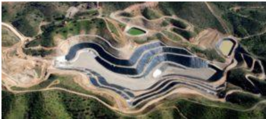
Ελεγχόμενος ΧΥΤΑ για μη επικίνδυνα απόβλητα. Πηγή: Grupotec. www.grupotec.es
