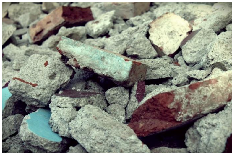
Εικόνα 5. Απόβλητα από σκυρόδεμα που προέκυψαν κατά την αποκατάσταση ενός αυτοκινητόδρομου από σκυρόδεμα (credit: Radu Gavrilescu)
