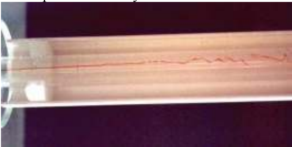
Figura 4 Regime di transizione (esperimento di Reynolds)
