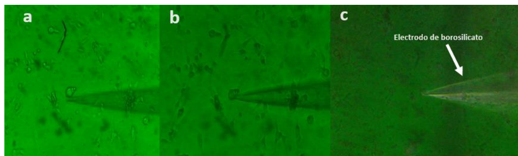
Figura 27. Técnica para lograr el parche de alta resistencia en electrofisiología. a) Electrodo aproximándose a la célula. b) Succión para lograr sellar la célula con el electrodo. c) Formando sello de alta resistencia.
