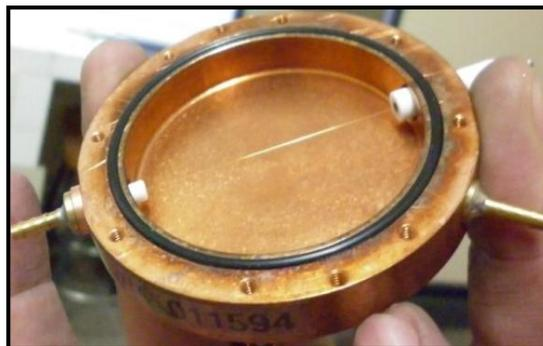
**Figura 5.** Geometría de un contador proporcional de bajo fondo
