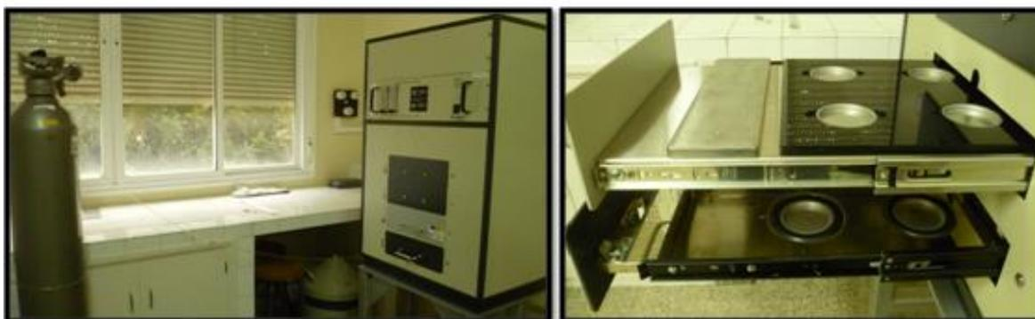
**Figura 12.** Vista del detector y al lado izquierdo se muestra el compartimento de la plancheta.
