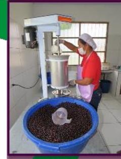
**DESPULPADO.** Para el despulpado de las frutas se usan equipos conocidos como despulpadoras de cilindro vertical o batideras. Estos equipos usan un movimiento rotatorio que hacen que se separe la pulpa de las semillas y la cáscara. Dependiendo de la capacidad de la máquina requiere entre 3 a 5 minutos de batido, y se echa agua según la cantidad y calidad de pulpa que se requiere. En el mercado las pulpas de mayor espesor son más valoradas porque rinden más jugo.
