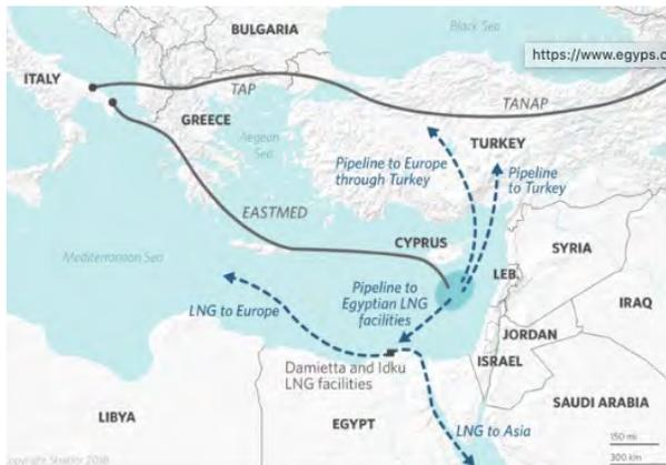
Potenziale tracciato del gasdotto EastMed. In alto il percorso del gasdotto TANAP-TAP (Fonte: Statfor 2018).
