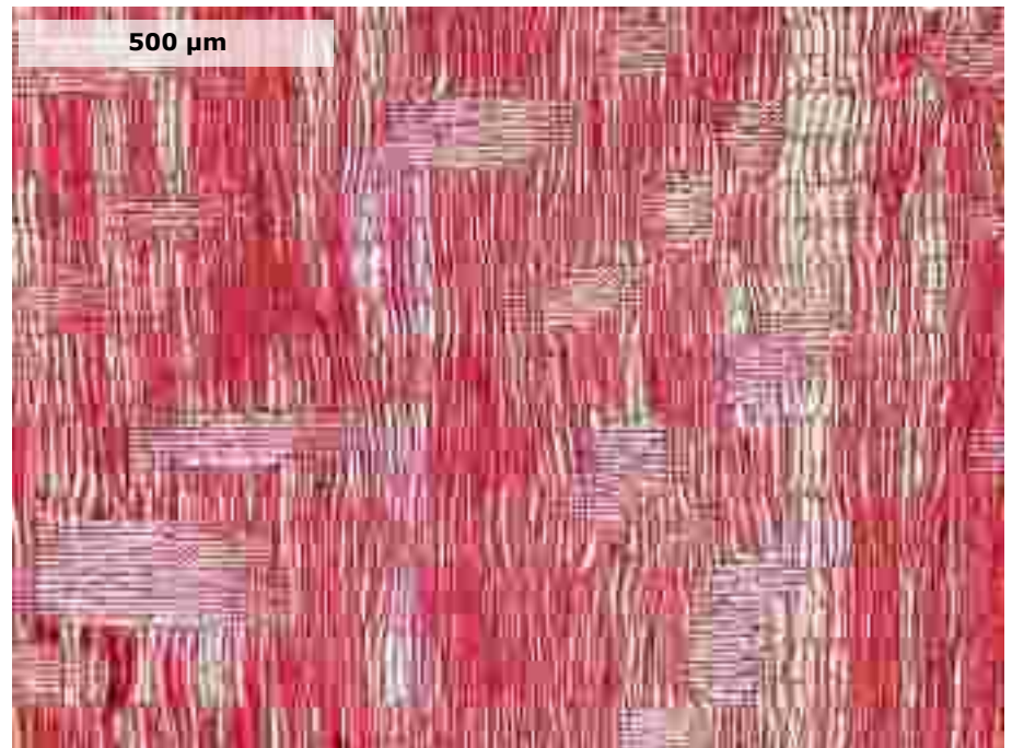
Figura 18. Vista longitudinal radial de la madera de D. tucurensis . 5X. Los rayos de parénquima son heterogéneos. Hay abundante parénquima axial.
