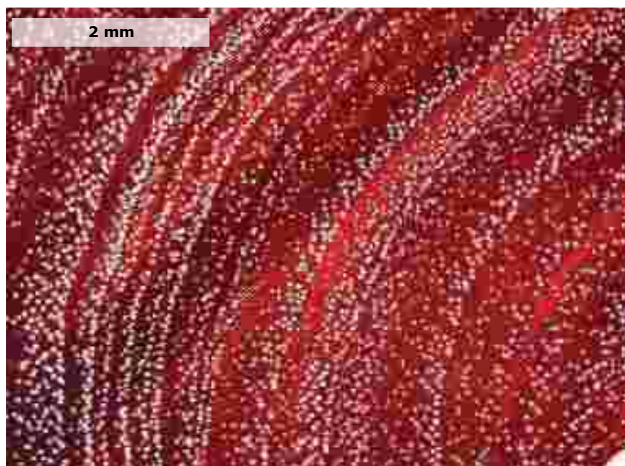
Figura 153. Vista transversal del duramen de G. sanctum . 1.25X. Porosidad semi-circular, anillos marcados.
