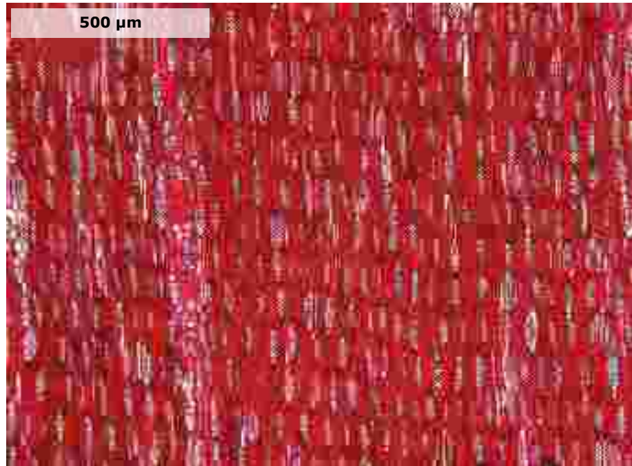
Figura 62. Corte Longitudinal Tangencial de la albura de D. calycina . 5x.
