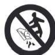
PROHIBIDO PISAR SUELO NO SEGURO
