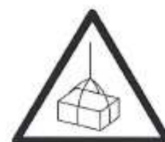
RIESGO CARGAS SUSPENDIDAS
