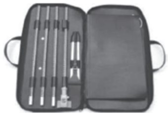
Figura 4. El antropómetro tipo Martin está conformado por cuatro segmentos que se ensamblan para medir la estatura.
