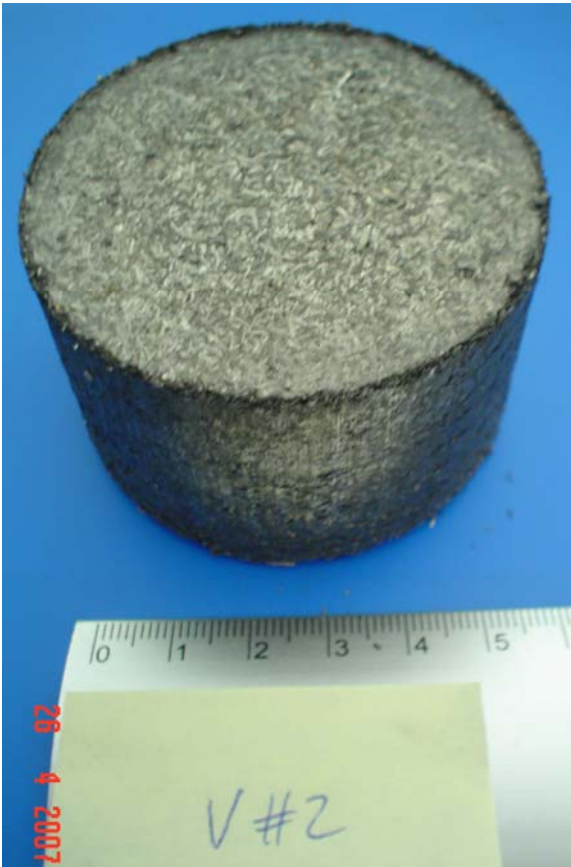
Abbildung 3: Ti-Spänebrikett Schmiermittel Blasocut BC 25 (I)
