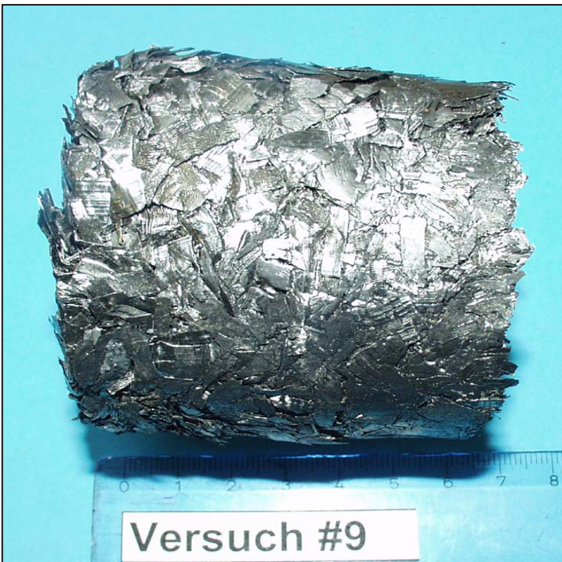
Bild 9.4.2: Pressling aus Titanspänen ohne Beimischung, jedoch h/d = 1,06
