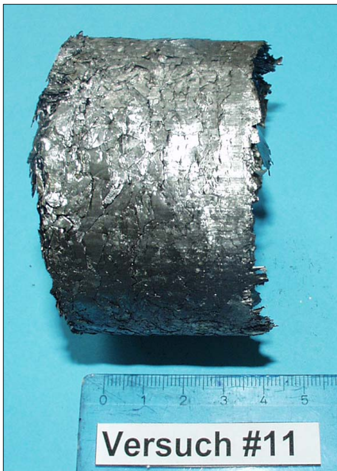
Bild: 9.4.4: Presslinge aus 3.7164 mit (#11) bzw. ohne (#23) Kühlschmierstoff
