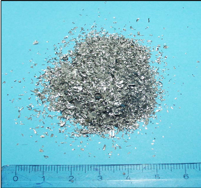
Bild 9: Späne aus Leg 90/6/4, feine Qualität
