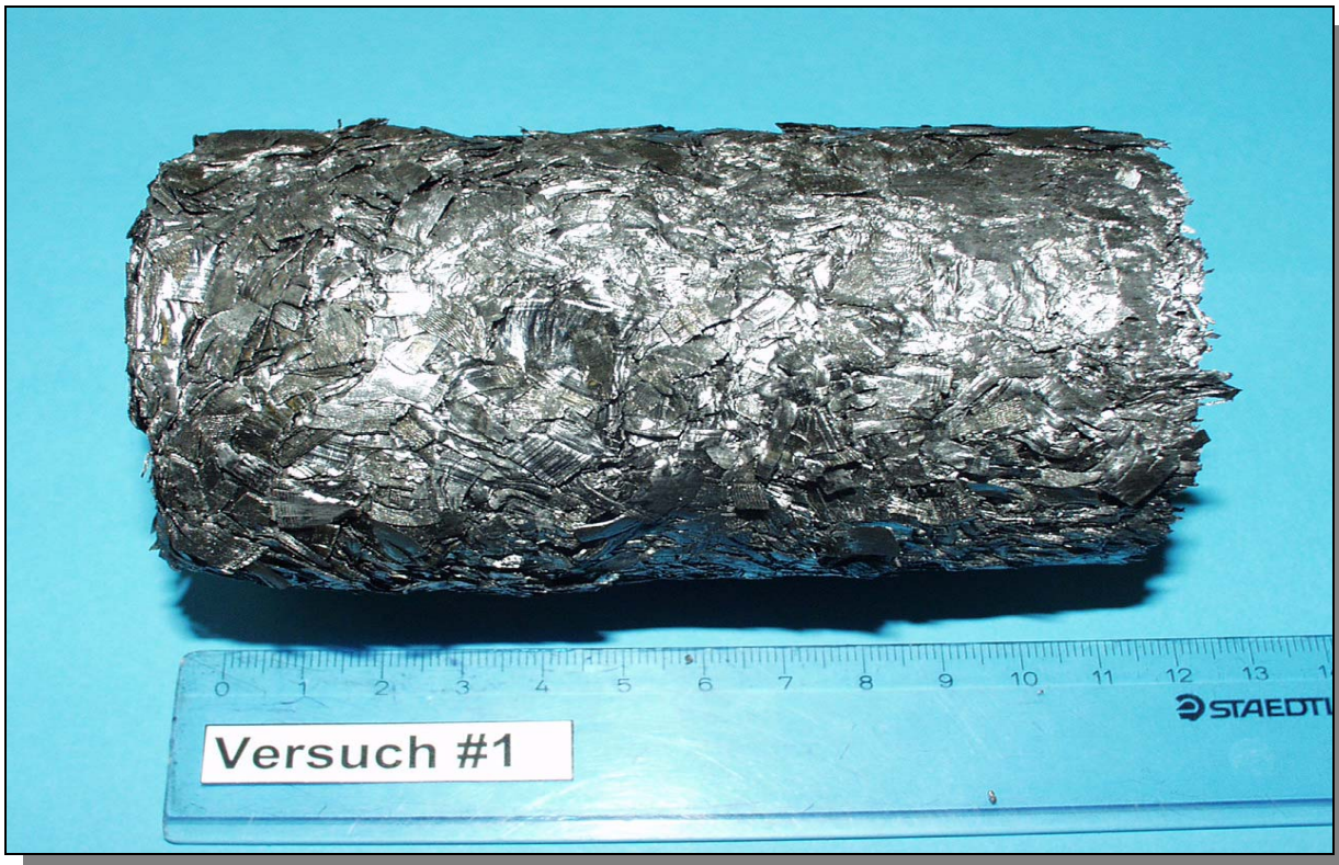
Bild 9.4.1: Pressling aus Titanspänen ohne Beimischungen
