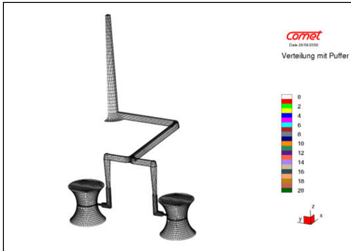
Bild 19 Viertelmodell der Verteilung mit 2 Puffern
