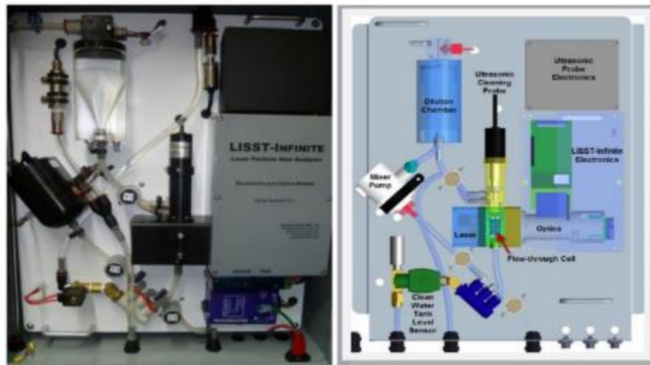
I. Equipo instalado en la cámara de válvulas del embalse La Esmeralda que toma muestras aleatorias del agua que está entrado a las bocatomas
