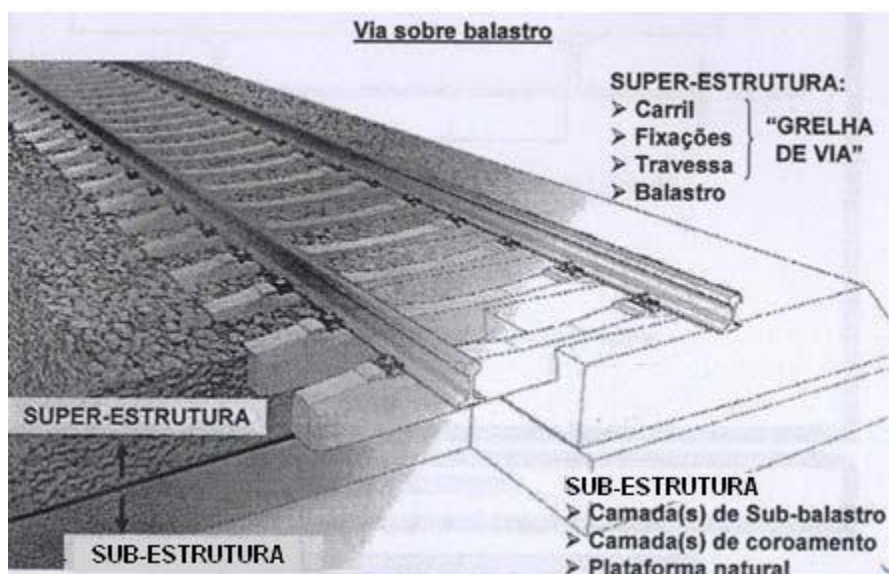
Fig. 5 – Esquema Secção Transversal Via Balastrada [6]
