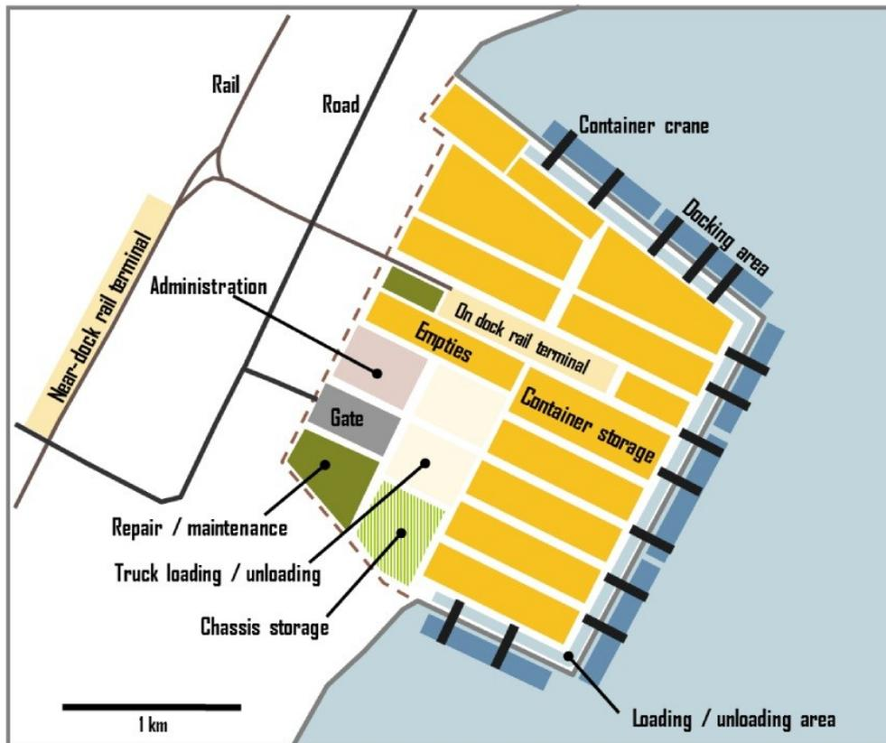
Figura 22 - Configuração de um terminal marítimo de contentores.
