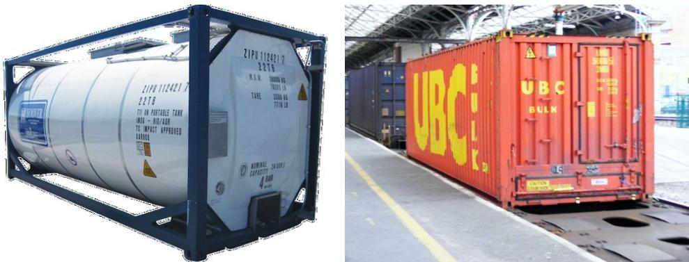
**Figura 21 - Contentor tanque (à esquerda) e contentor preparado para o transporte de granel (à direita).**
