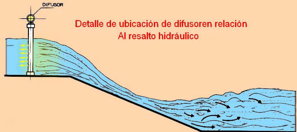
Cámara de contacto de cloro
