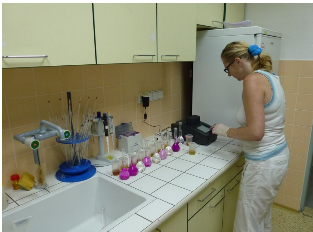
Obrázek 17: Měření na přístroji Spektrofotometr HACH typu DR 2800
