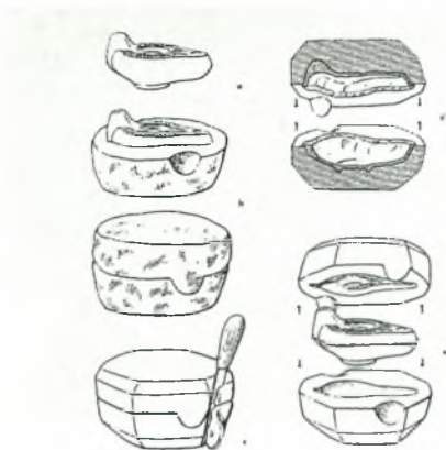
Εικόνα 206. Προετοιμασία μήτρας (matrix) από ένα αρχέτυπο (patric) και δημιουργία λυχναριού από τη μήτρα αυτή (Goethert, Lampen und Leuchter , σ. 17).
