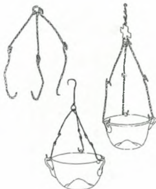
Εικόνα 743. Σχεδιαστική απόδοση συστημάτων ανάρτησης καντήλων με μεταλλικά νήματα που προσαρτώνται στις λαβές των γυάλινων καντήλων, Δαλματία (Chevalier, Dalmatie , σ. 198, εικ. 9).
