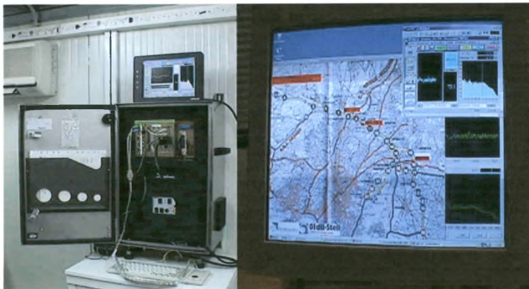
Σχ. 10 Άποψη εσωτερικού μόνιμου σταθμού παρακολούθησης ΟΚΘ και αποστολή πληροφορίας στο ΚΕΣ
