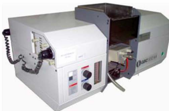
Εικόνα 11: Ατομική Απορρόφηση με φλόγα (FAAS)
