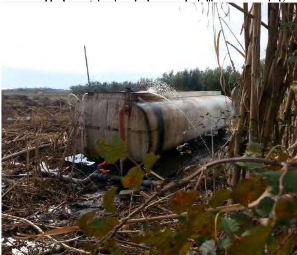
Εικόνα 9: Διαρροή σε δεξαμενή αποβλήτων από βιομηχανία τυποποίησης ελαιών
