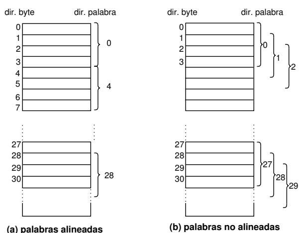
Figura 8.11: Direcciones alineadas y no alineadas en una arquitectura de 32 bits.
