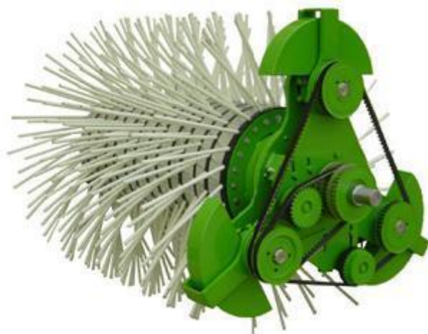
Fig. 2.9 – “Escovas” para separação do tomate da rama
