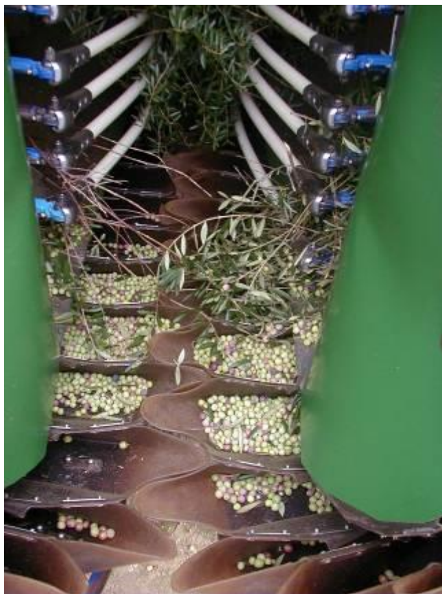
Fig. 1.27 - Transportador contínuo de godés deformáveis Máquina Braud New Holland na Quinta de Vale de Lobos (Ribatejo)
