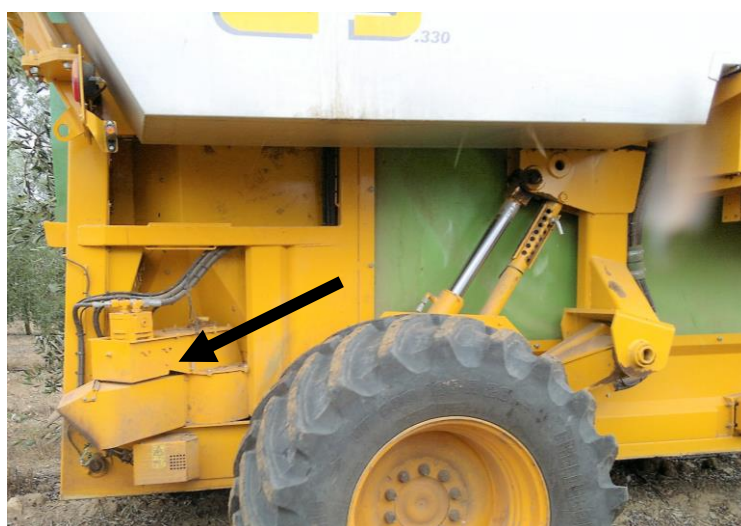
Fig. 1.33 – Extractor de limpeza inferior na traseira de uma máquina Gregoire. Torre das Figueiras, 2017
