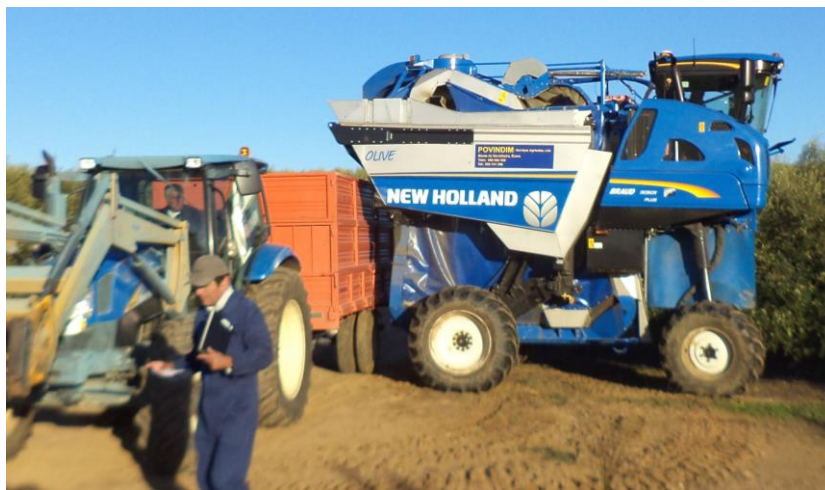
Fig. 1.8 – Altura máxima para descarga em semi-reboque de taipais altos. Olivais do Sul, 2016
