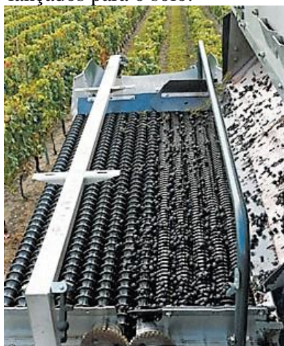
Fig. 1.34 – Crivo de roletes para limpeza http://www.pellenc.com/
