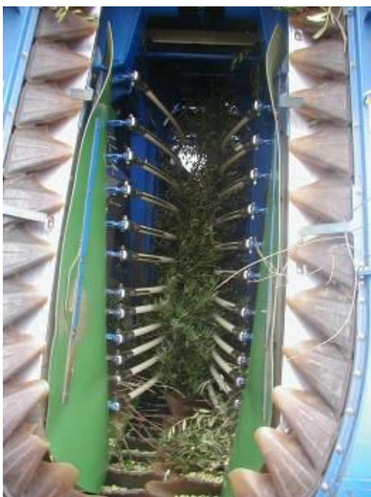
Fig. 1.20 – Máquina Braud New Holland na colheita de azeitona na Quinta de Vale de Lobos (Ribatejo) 2006
