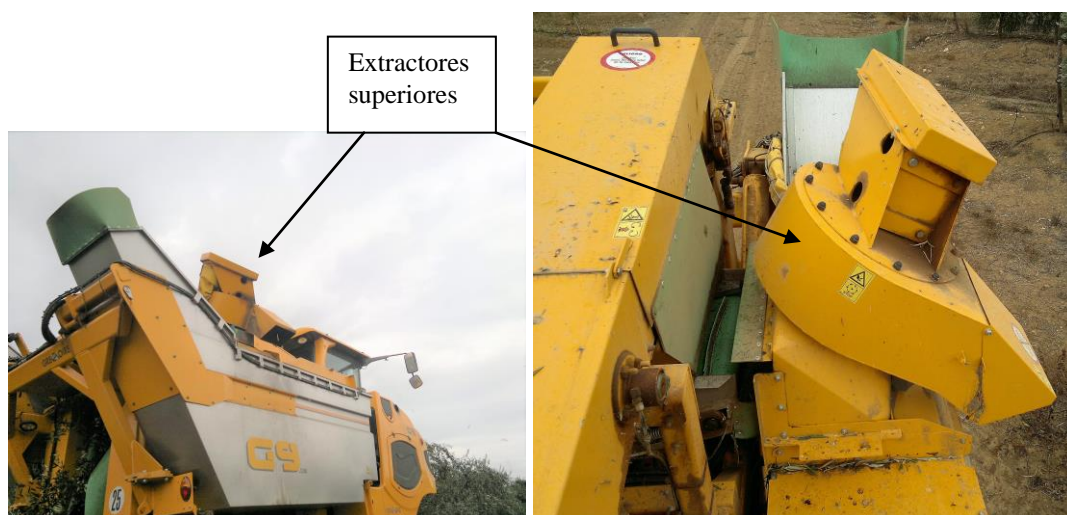
Fig. 1.32 – Extractor de limpeza superior de uma máquina Gregoire. Torre das Figueiras, 2017
