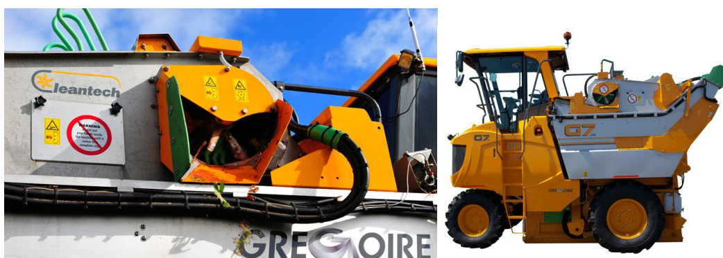
Fig. 1.36 – Sistema de limpeza e para desengajar http://www.gregoire.fr
