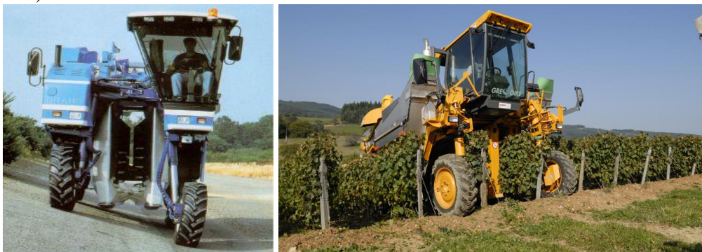
Fig. 1.9 – Concepção que permite nivelamento
