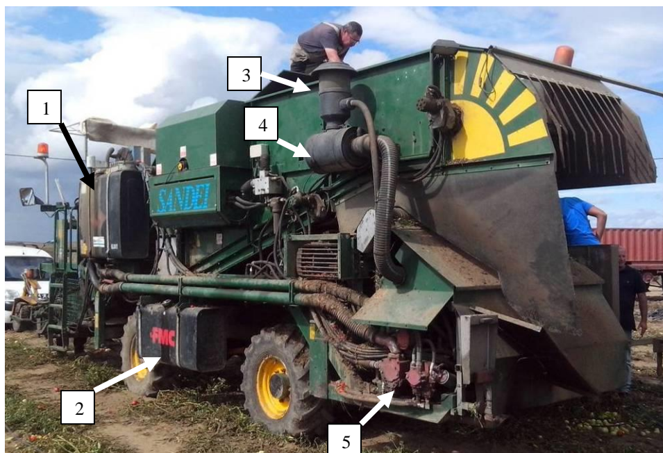
Fig. 2.2 – Máquina MTS – Sandet: (1) Reservatório do óleo do sistema hidráulico; (2) Depósito de combustível; (3) Pré filtro de ar do motor Diesel; (4) Filtro de ar seco do motor Diesel; (5) Bombas do sistema hidráulico. Herdade do Falcão (Évora) - 2014
