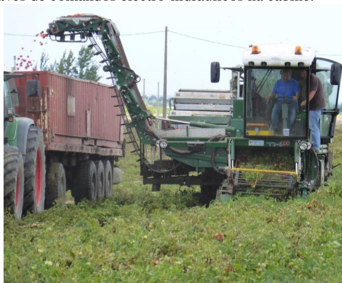
Fig. 2.20 – Transportador elevador de descarga numa máquina MTS-Sandet. Herdade do Falcão (Évora) - 2014
