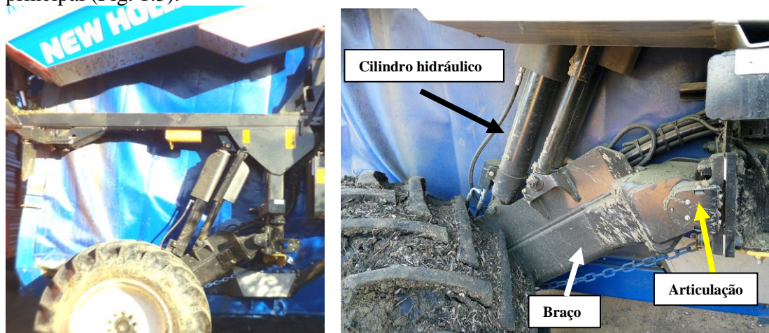
Fig. 1.5 – Braço articulado da roda traseira direita, actuado por cilindro hidráulico. Visita de estudo aos Olivais do Sul, 2016 e 2017
