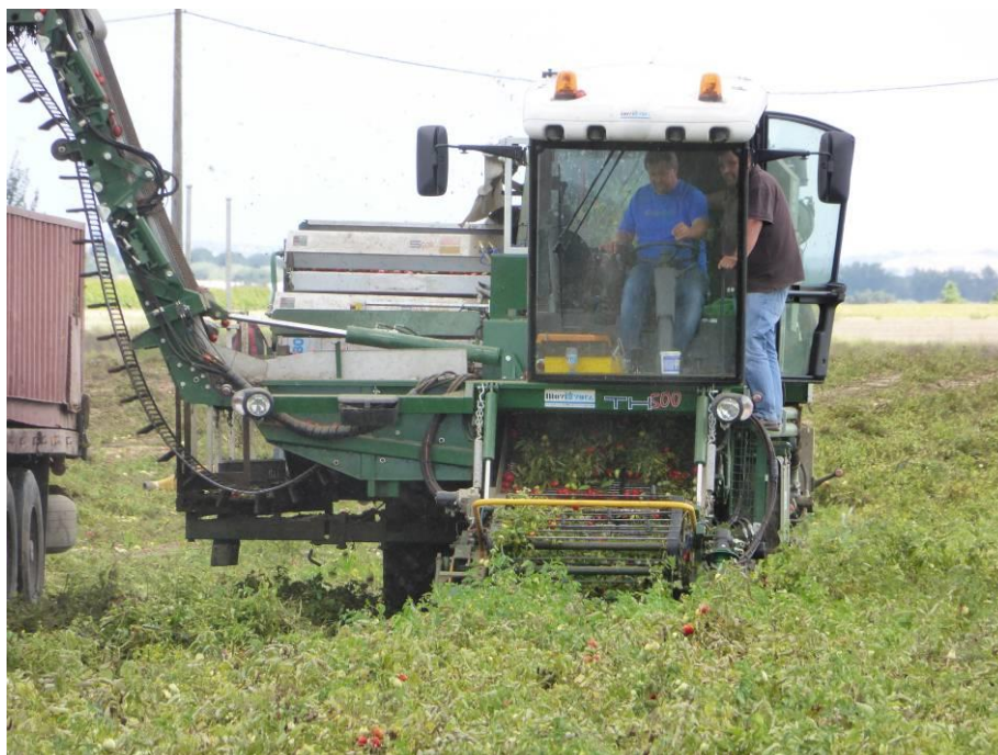
Fig. 2.21 – Posto de condução numa máquina MTS- Sandet. Colheita de tomate na Herdade do Falcão (Évora) - 2014
