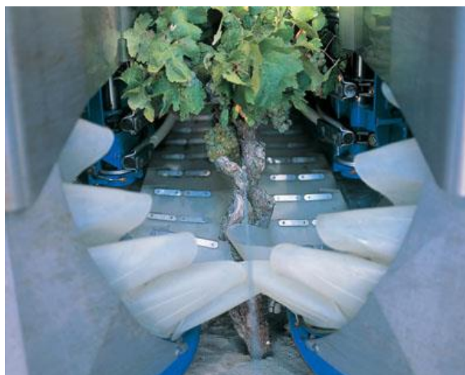
Fig. 1.28 – Godés fechando-se em torno de uma cepa. http://www.newholland.com/
