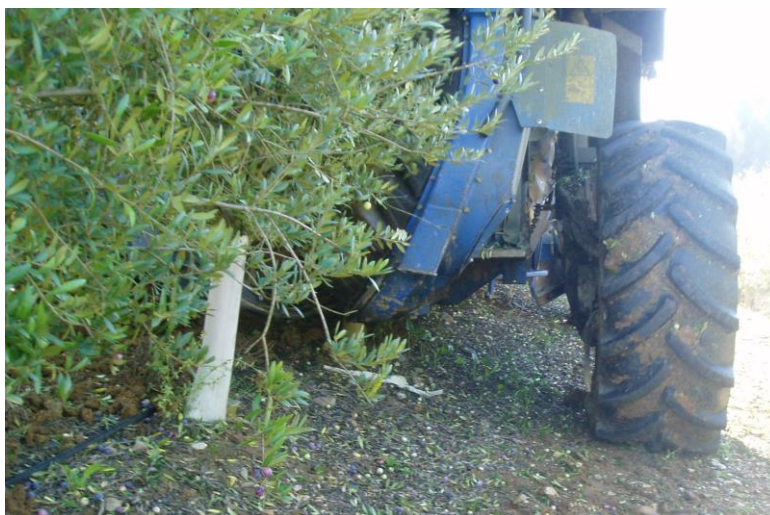
Fig. 1.7 – Altura mínima para colheita de azeitona junto da base. Santos Lima, 2006
