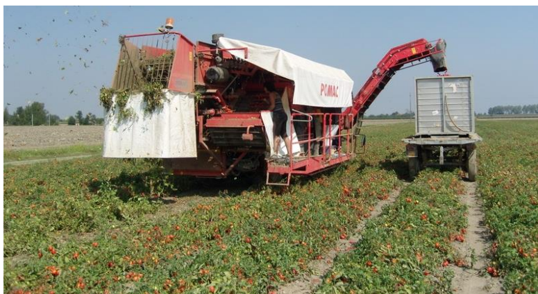
Fig. 2.11 - Saída da rama na parte posterior (Máquina POMAC)
