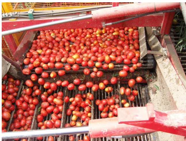
Fig. 2.13 – Tomate já seleccionado e limpo a ser transferido para o transportador de descarga (Máquina POMAC)
