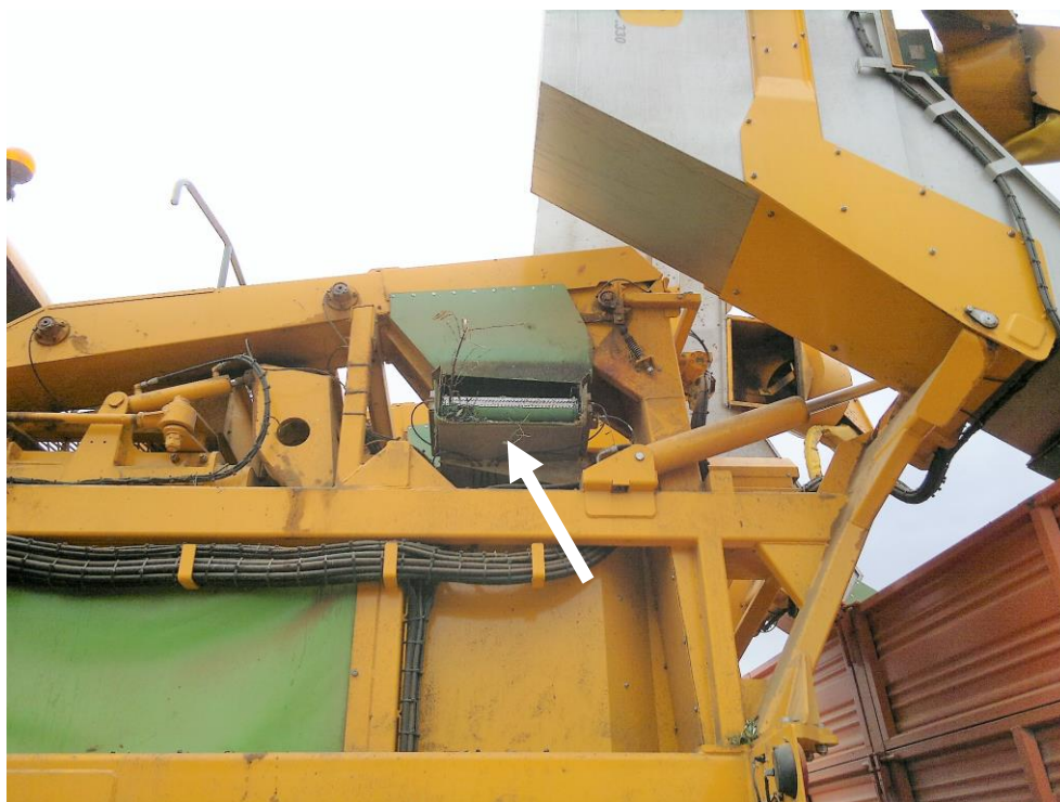
Fig. 1.30 - Transportador contínuo transversal esquerdo Máquina Gregoire G9 330, na Herdade de Torre das Figueiras (Monforte)
