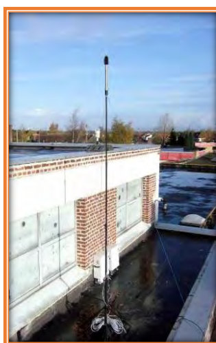
ΕΙΚΟΝΑ 5.8: ΜΟΝΙΜΟΣ ΣΤΑΘΜΟΣ ΚΑΤΑΓΡΑΦΗΣ ΠΕΡΙΒΑΛΛΟΝΤΙΚΟΥ ΘΟΡΥΒΟΥ DUO
