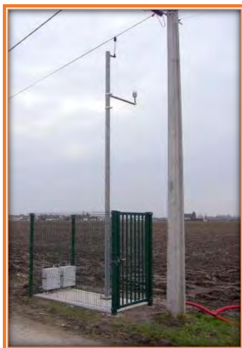
ΕΙΚΟΝΑ 5.8: ΜΟΝΙΜΟΣ ΣΤΑΘΜΟΣ ΚΑΤΑΓΡΑΦΗΣ ΠΕΡΙΒΑΛΛΟΝΤΙΚΟΥ ΘΟΡΥΒΟΥ DUO
