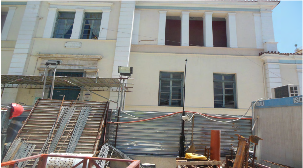
ΕΙΚΟΝΕΣ 7.9: ΕΡΓΟΤΑΞΙΟ «ΔΕΛΗΓΙΑΝΝΗ»- ΑΥΤΟΝΟΜΟΣ ΚΙΝΗΤΟΣ ΣΤΑΘΜΟΣ ΘΟΡΥΒΟΥ ΜΕ ΣΤΑΤΙΣΤΙΚΟ ΑΝΑΛΥΤΗ ΚΑΙ ΔΙΑΤΑΞΗ ΠΑΝΤΟΣ ΚΑΙΡΟΥ (ΣΕ ΕΙΔΙΚΟ ΙΣΤΟ) ΤΥΠΟΥ SOLO
