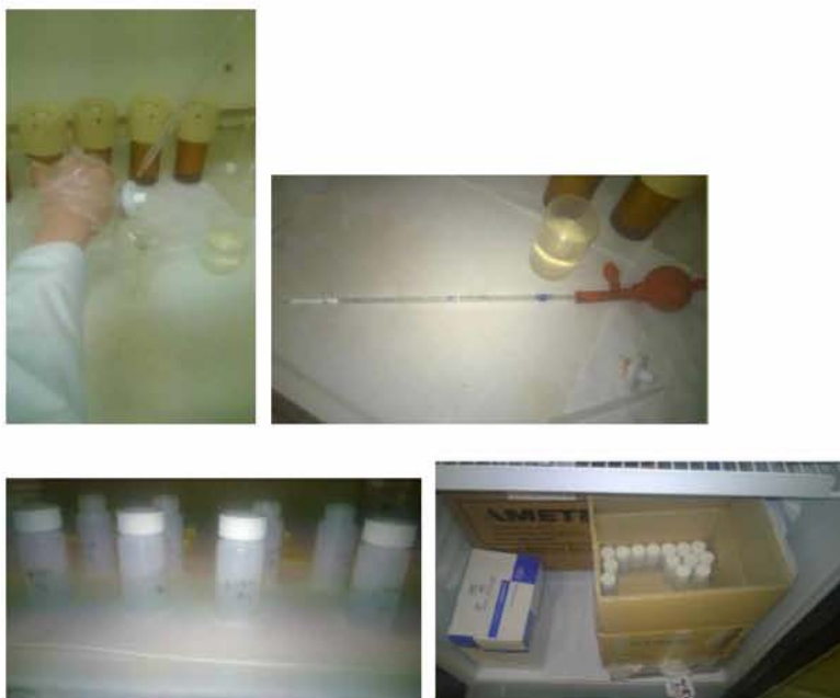
Εικόνες 11.2.5.3 (α,β,γ,δ): Διαλυτοποίηση των φίλτρων της δειγματοληψίας μέσω της χώνευσης- φύλαξη.
