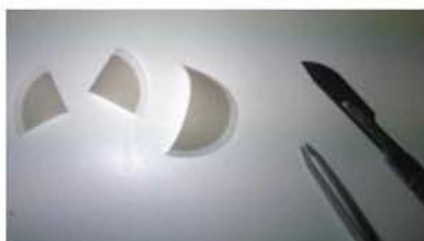
Εικόνα 11.2.5.1: Διαχωρισμός φίλτρου ούτως ώστε να αναλυθεί με διαφορετική τεχνική.
