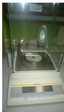
Εικόνα 11.1.4: Αναλυτικός ζυγός 5 δεκαδικών ψηφίων που χρησιμοποιήθηκε για τις ζυγίσεις των φίλτρων στις εγκαταστάσεις του ΕΚΕΦΕ Δημόκριτος.
