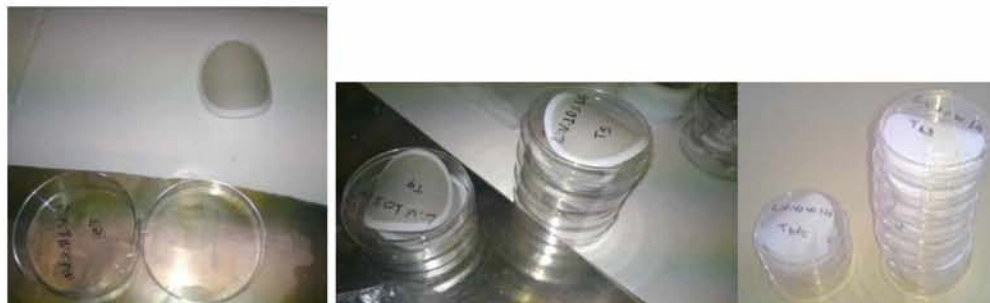
Εικόνες 11.1.3 (α, β, γ): Χρησιμοποιημένα φίλτρα αριστερά και αχρησιμοποίητα δεξιά τοποθετημένα σε τριβλία (petri), πολυστυρενίου.
