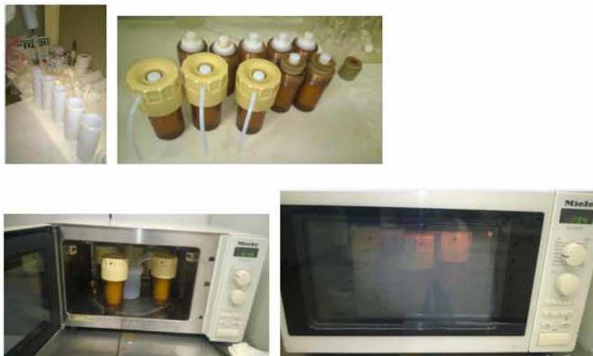
Εικόνες 11.2.5.2 (α,β,γ,δ): Διεργασία καθαρισμού δοχείων Teflon και χώνευσης των δειγμάτων με χρήση φούρνου μικροκυμάτων.
