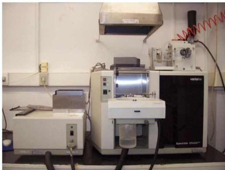
Εικόνα 11.2.1: Φασματοφωτόμετρο Ατομικής Απορρόφησης Varian 220 με ηλεκτροθερμαινόμενο φούρνο γραφίτη GTA 110.
