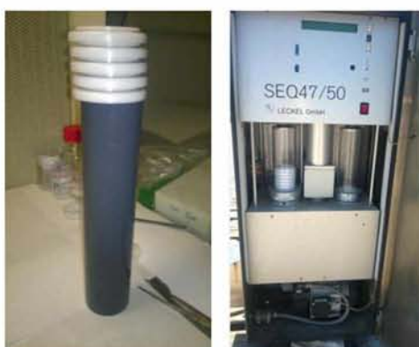
Εικόνες 11.1.2 (α, β): Ειδικές κασετίνες όπου τοποθετούνται τα φίλτρα κατά τη διάρκεια της δειγματοληψίας.
