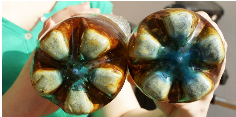
Obrázek 19: Loužící kolony zhotovené z plastu po 14 dnech loužení. (foto: autor)
