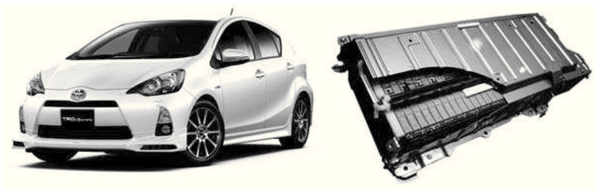
Obrázek 8: Hybridní automobil Toyota Prius a NiMH akumulátor z téhož automobilu [25] [26]
