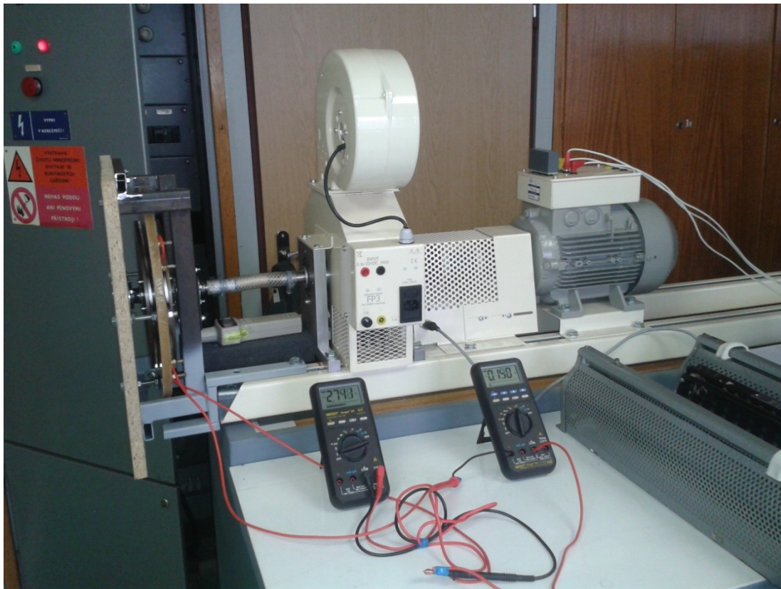
Příloha B: Měření otáček generátoru
