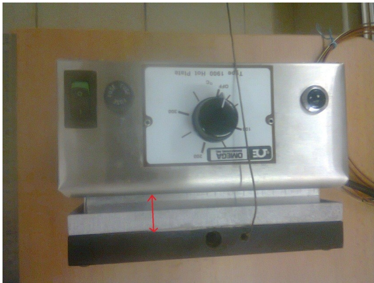
Obr. 8.3 možná příčina rozdílu v naměřených teplotách [foto autor]
