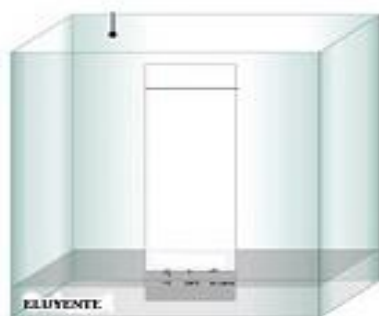
Figura 10. Representación de la cromatografía en capa fina en la que aparece una placa TLC (fase estacionaria) inmersa en el eluyente (fase móvil). ( www.waters.com/waters/es_ES/HPLC/nav.10048919.locale=es_ES ).
