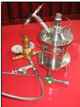
Figura 14. Imagen del extrusor Lipex® Thermobarrel.
