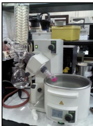
Figura 12. Imagen del rotavapor empleado en la preparación de liposomas.
