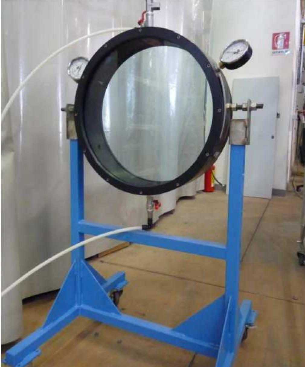
Fig.6. 1: Cella di contenimento della miscela
