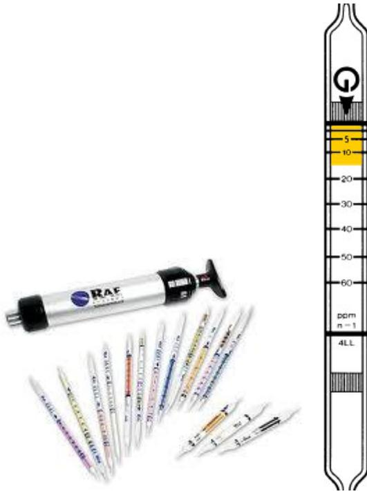
Fig.2. 3 : Fialette colorimetriche . A destra la fialetta indica, come esempio, una valore di concentrazione pari a 15 ppm di una sostanza non specificata.
