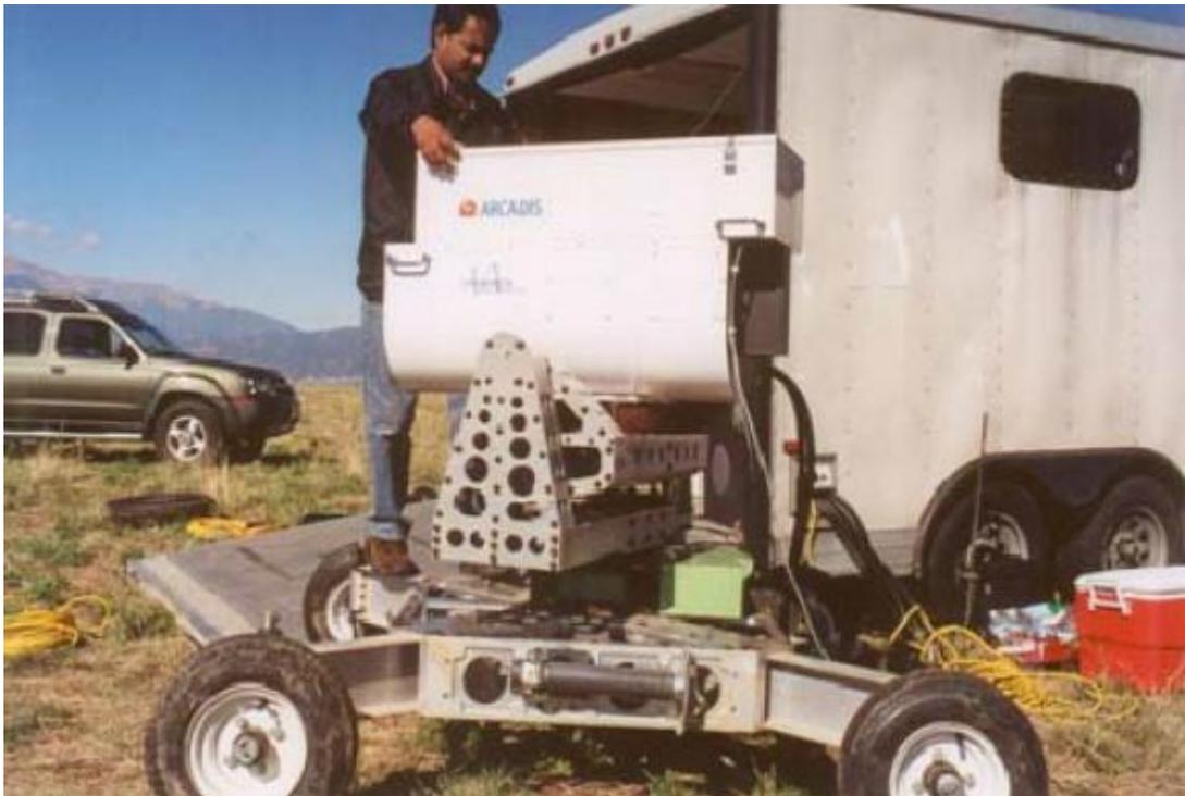
Figura 3.7 : Strumentazione OP-FTIR
