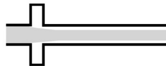
Obrázek 14: Stabilní paralelní proud dispergované fáze ( Q = 3 ) [9]
