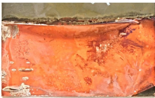
Obrázek č. 9 – Vzorek č.1: 2 A/dm 2 , bez leskutvorných přísad
