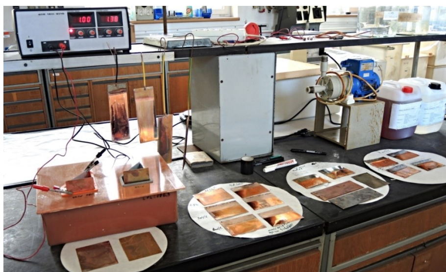
Obrázek č. 8 – ukázka pracoviště s Hulloovou celou
