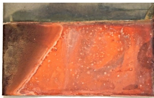
Obrázek č. 10 – Vzorek č.2: 5 A/dm 2 , bez leskutvorných přísad
