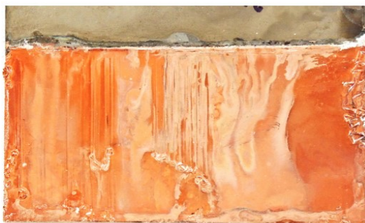
Obrázek č. 11 – Vzorek č.3: 2 A/dm 2 , 8 ml/l leskutvorných přísad
