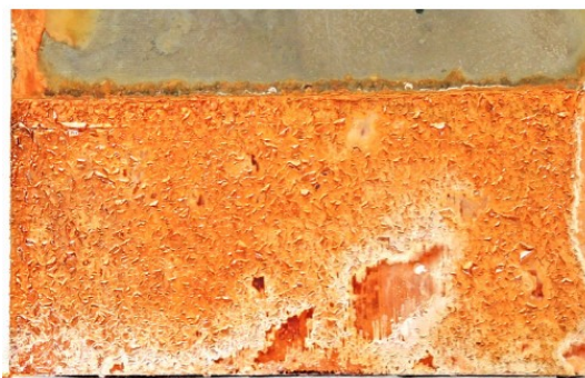
Obrázek č. 13 – Vzorek č.5: 2 A/dm 2 , 16 ml/l leskutvorných přísad
