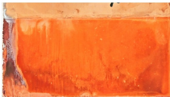
Obrázek č. 17 – Vzorek č. 9: 2 A/dm^2 , 2 ml/l leskutvorných přísad
