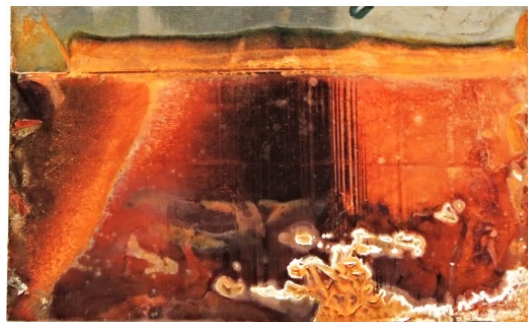
Obrázek č. 12 – Vzorek č.4: 5 A/dm 2 , 8 ml/l leskutvorných přísad
