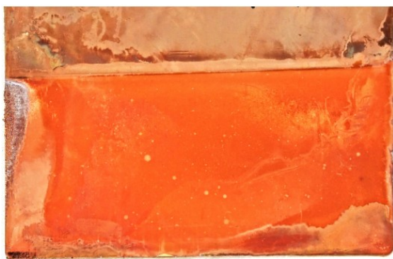
Obrázek č. 19 – Vzorek č. 11: 2 A/dm 2 , 4 ml/l leskutvorných přísad
