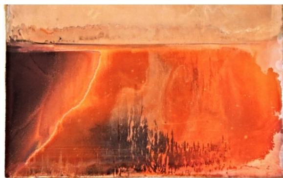
Obrázek č. 20 – Vzorek č. 12: 5 A/dm 2 , 4 ml/l leskutvorných přísad
