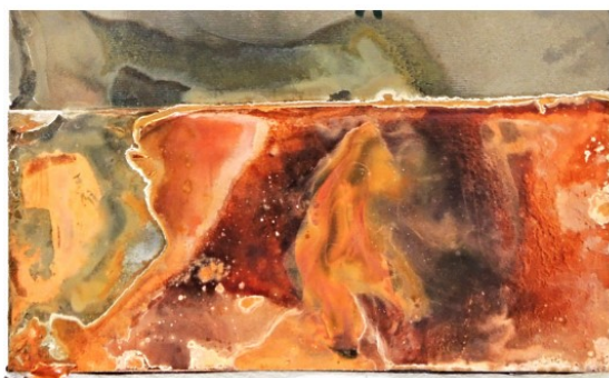
Obrázek č. 14 – Vzorek č.6: 5 A/dm 2 , 16 ml/l leskutvorných přísad
