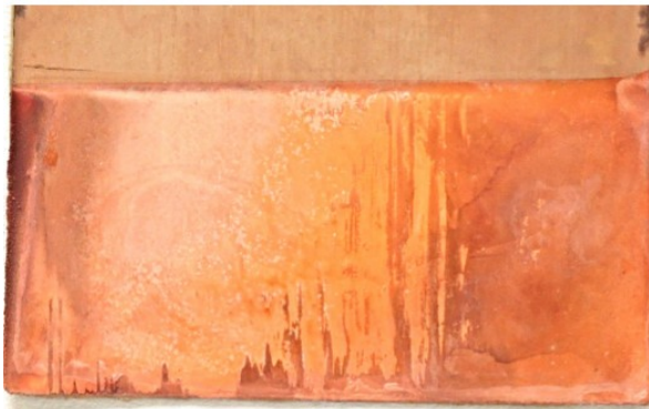
Obrázek č. 15 – Vzorek č. 7: 2 A/dm^2 , bez leskutvorných přísad
