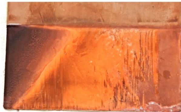
Obrázek č. 16 – Vzorek č. 8: 5 A/dm^2 , bez leskutvorných přísad
