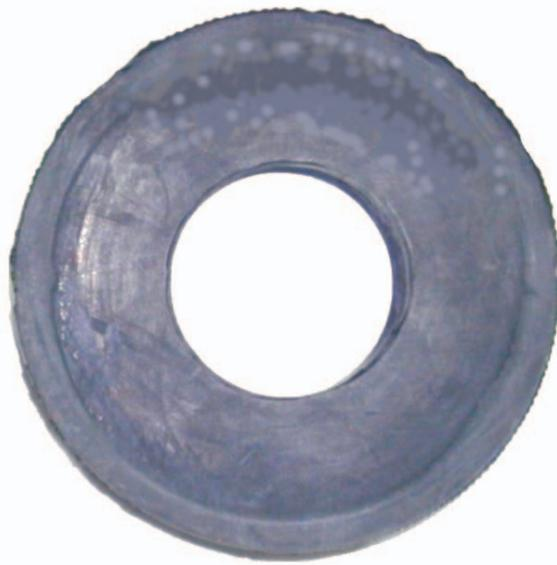
**Bild 2.6:** Groschrad-Rohling, etwa handteller groß, wie er in der Reifenindustrie für Verschleißmessungen verwendet wird („*Grosch-Abrader*“, siehe GROSCH [27])
