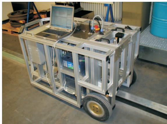
**Bild 3.1:** Das Messmobil im Einsatz: a) Messung auf Asphalt; b) Messungen unter Laborbedingungen. Auf einer Trägerschiene können unterschiedliche Oberflächen als Kontaktpartner des Groschrades montiert werden
