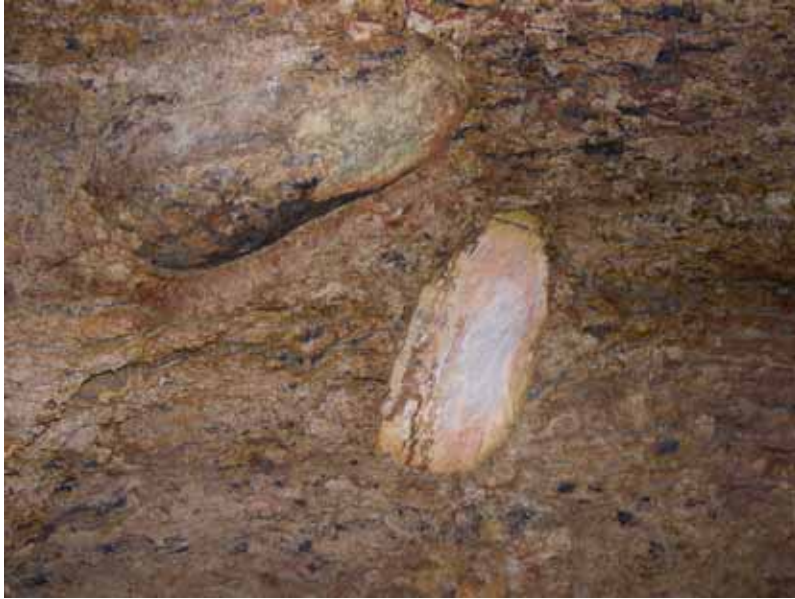
Figura 6 – Sensibile alterazione dei sedimenti dell'Unità di Fiano, caratterizzati da ciottoli completamente argillificati e da una matrice di colore rosso che mostra una sensibile cementazione da parte degli ossidi di ferro.
