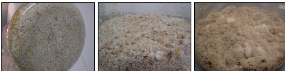
Abbildung III-34: Festphasenfermentation (Solid-State Fermentation – SSF) von A. nidulans (II.11.4.1) auf Reis (linke und mittlere Abbildung) sowie Weizenkleien (rechte Abbildung).
