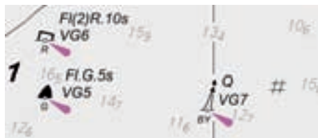
■ Op dit stukje van de kaart zie je drie boeien in de vaargeul naar Zeebrugge. Het symbooltje linksbovenaan toont een rode, laterale, stompe boei met een rood licht. Fl(2)R.10s betekent dat deze boei een groepsschitterlicht geeft. Het licht knippert twee maal en dan blijft het donker gedurende de resterende 6 seconden. Samen duurt zo'n cyclus dus 10 seconden. Het symbooltje links onderaan is een groene, spitse laterale boei. Fl.G.5s betekent dat deze boei een groen schitterlicht geeft dat eens om de 5 seconden knippert. Deze boei dient dus aan stuurboordzijde gepasseerd te worden om de juiste vaarroute te bevaaren. Het symbooltje rechts staat voor een meerkleurige, zwart-geel horizontaal gestreepte kardinale boei (VH)
