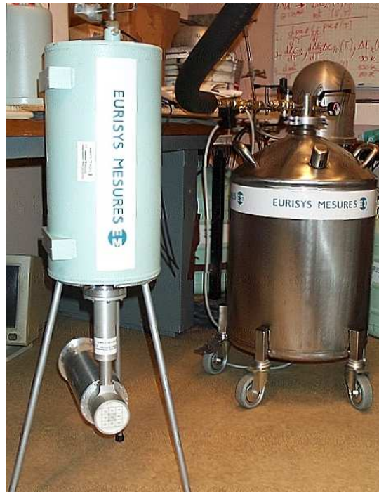
FIG. 3.12: Photographie de l'ensemble cryostat+détecteur.
