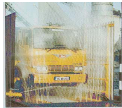
Figura 19- Exemplos de máquinas de lavagem de rodas e chassis para estaleiros de construção
