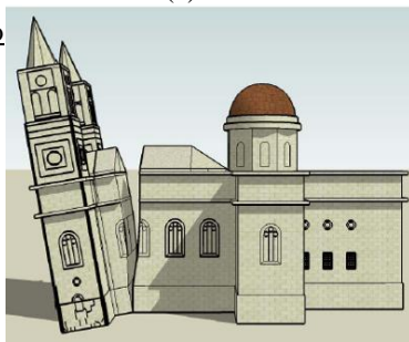
Figura 9: Mecanismo de colapsos: (a) derrubamento da torre esquerda; (b) derrubamento da torre direita; (c) derrubamento global da fachada; (d) derrubamento do frontão. (FS é o factor de segurança)
