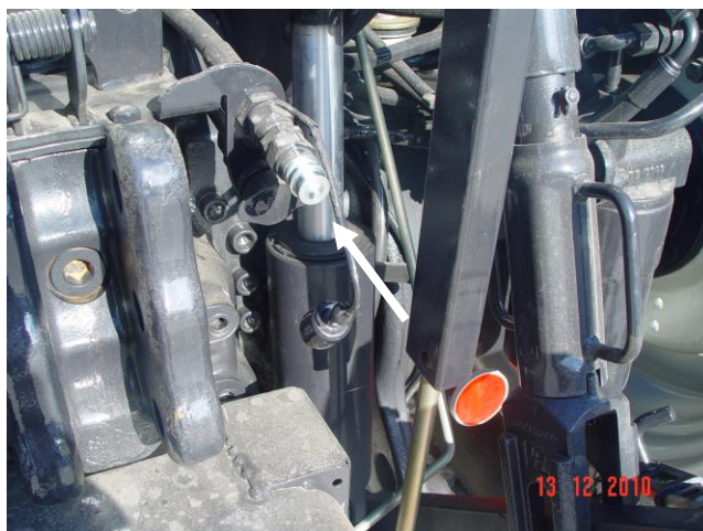
Tractor Vatra N82 - Tomada de retorno de baixa pressão ( free flow return line )
