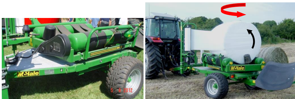
Mesa rotativa em torno de dois eixos
