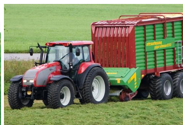
Semi-reboque auto-carregador de forragem
