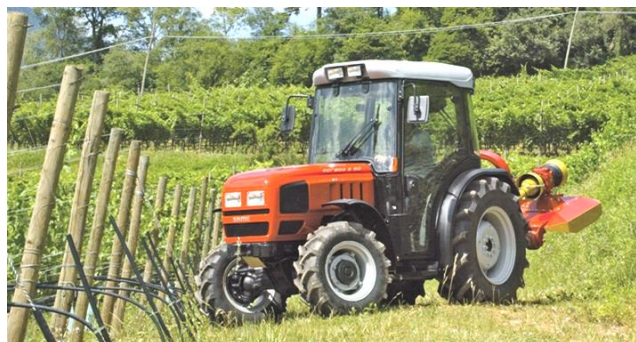
Volta nas cabeceiras de uma vinha – desligar a tdf
