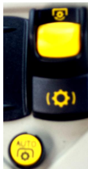
Comando eléctrico hidráulico da embraiagem e comando de embraiagem automático (coordenado com o levantamento dos braços inferiores do sistema hidráulico).
