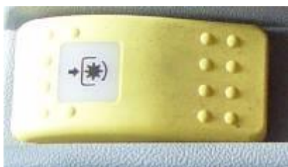
Comando eléctrico hidráulico da embraiagem da tdf
