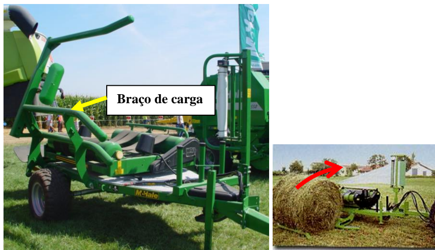
Braço de carga do fardo para a mesa rotativa www.mchale.net
