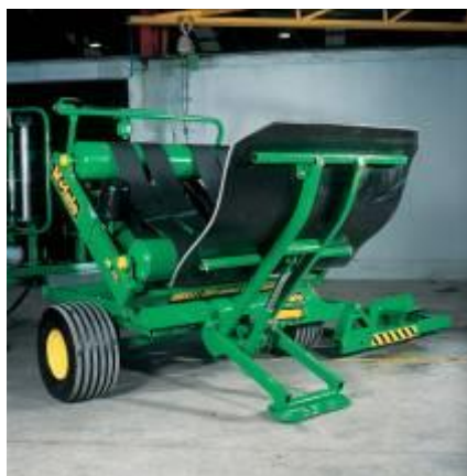
Rebatimento da mesa rotativa para evacuar o fardo
