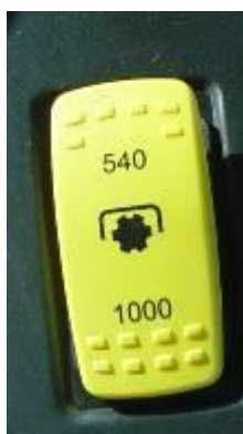
Comando eléctrico hidráulico da caixa de velocidades da tdf
