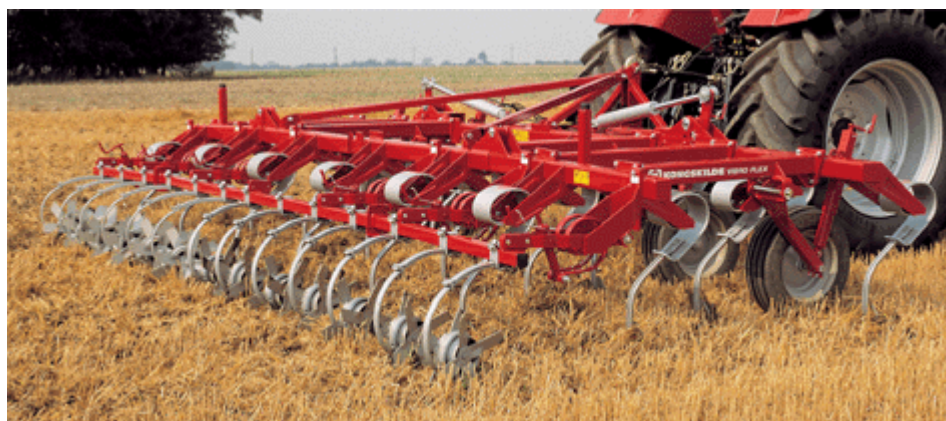
Os cilindros hidráulicos deverão estar ligados a válvula do SESH com flutuação
