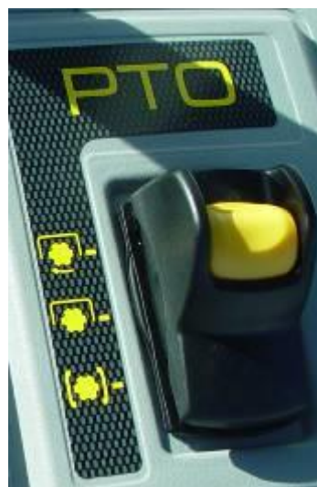
Comando eléctrico hidráulico da embraiagem da tdf
