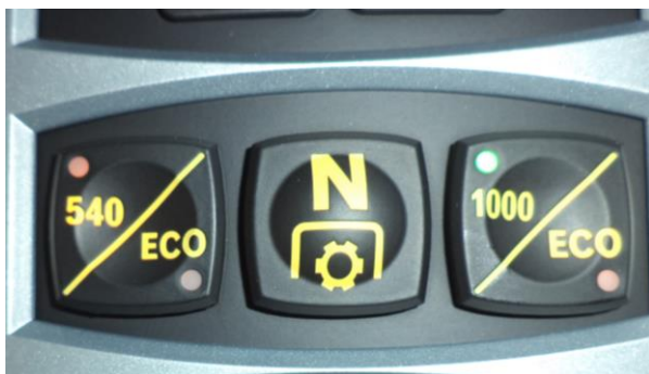
Comando eléctrico hidráulico da caixa de velocidades da tdf
