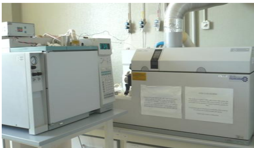
Figura 14. Sistema GC-(ICP)QMS con celda de colisión/reacción
