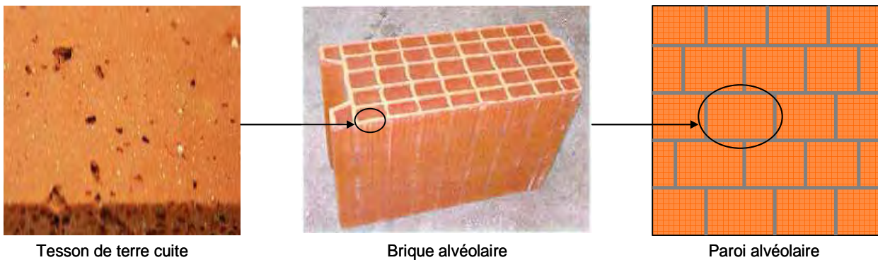
Figure I.3 Illustration du caractère multi-échelle d'un mur alvéolaire.
