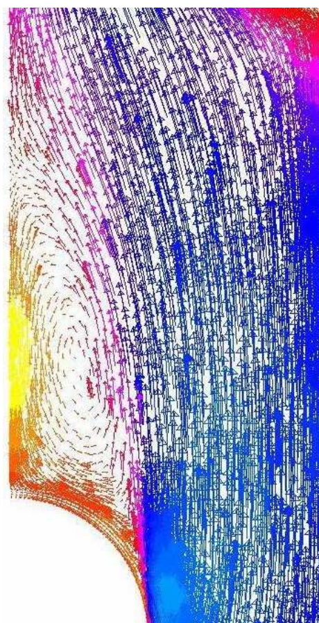
Obr. 4.9 Znázornění vektorů rychlosti za trubkou
