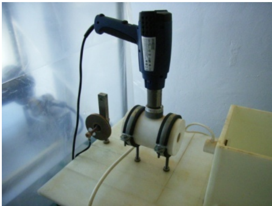
Obr. 8.9. Vysoušecí tunel s horkovzdušnou pistolí
