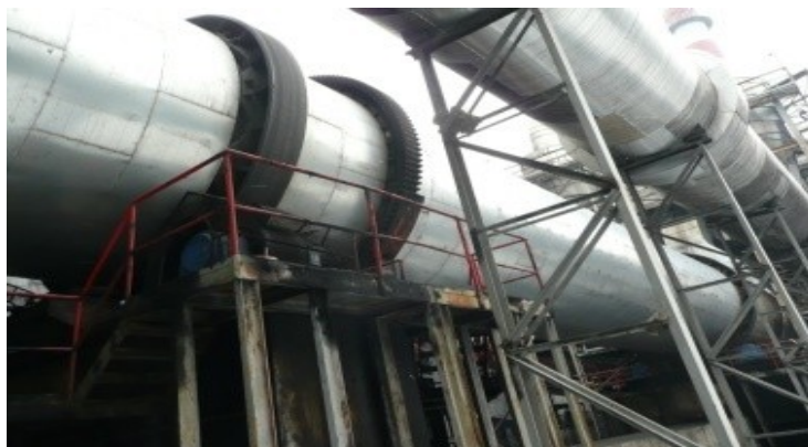
Obr. č. 12 - Pohled na rotační pec Dolu Darkov pro sušení černouhelných kalů
