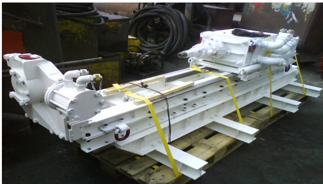
Obr. č. 7 – V OKR nově nasazovaná vrtná souprava TURMAG
